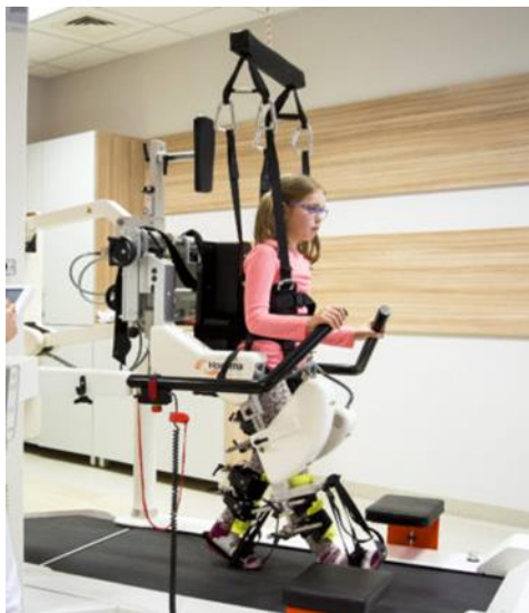
Slika 8. Hod uz pomoć lokomata
